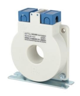
,补偿方法先进,工艺技术精湛,性能安全可靠,外形小巧美观,种类齐全,一般作控制、保护、测量用途。重要参数:额定绝缘电压□AC660V工频耐压□3kV□50Hz·1min,外壳与二次线圈间)比较高保护等级□5P20比较大一次侧电流□6300A比较高5P20的等级,满足低压电路的比较大保护需求。一次侧电流比较高可至6300A□多种规格可选,适用不同安装环境。外壳采用环保PC材质。技术参数:1.一次电流5~3000a二次电流5a□1a2.额定电压ac660v3.额定频率50~60hz4.环境温度-30℃~+70℃最高耐温120℃5.海拔高度≤3000m□
